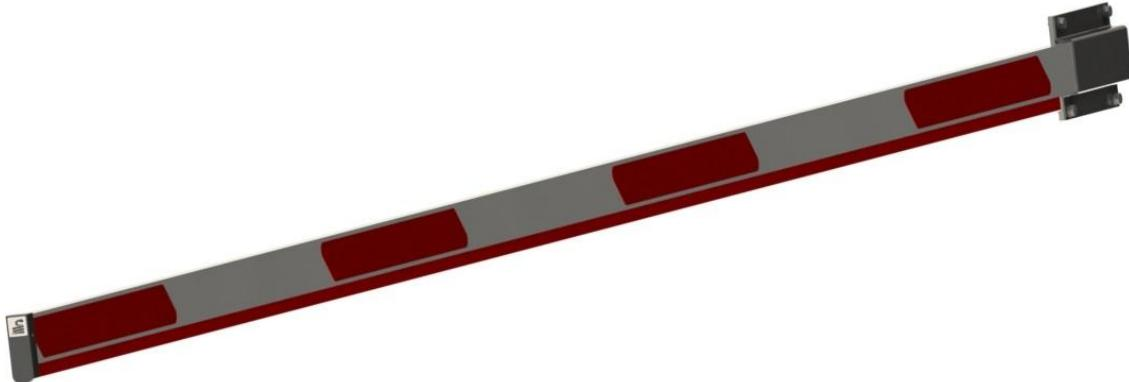
Стрелы Р2(60)-Р4(60) выполнены из прочного алюминиевого профиля сечением 60x21. Снизу профиля установлен мягкий вкладыш для снижения травмоопасности. На поверхность стрелы нанесены специальные светоотражающие полосы в виде наклеек, которые хорошо видны в темноте при попадании на них источника света, например, от фар.
